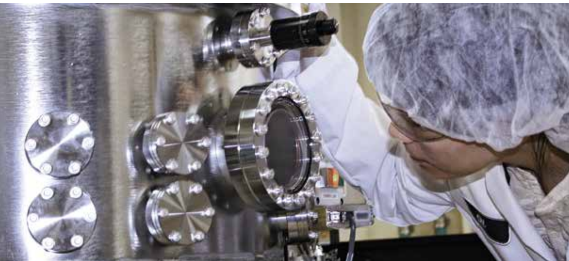
H.C. Starck Solutions の薄膜研究施設では、様々な条件下での試験ターゲットのスパッタリングが可能となっています。
